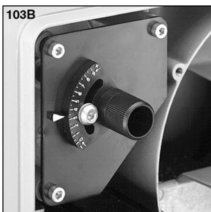
**Регулировка подачи воздуха посредством воздушной заслонки**
